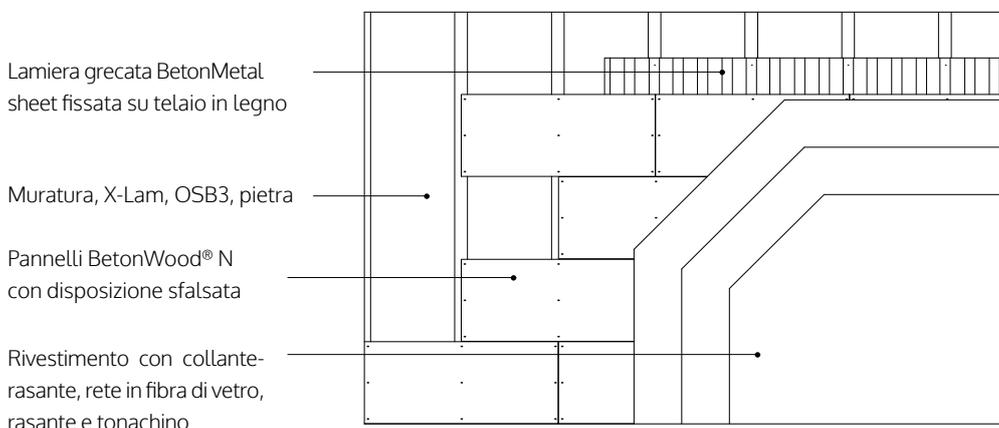
Nel caso di strutture isolanti può essere corredata da materiali ad elevato sfasamento termico come la nostra fibra di legno **Fibertherm®** o le nostre **fibre sfuse** poste nell'interasse.
