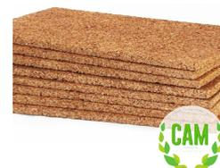
Pannello in sughero biondo densità 150÷180 kg/m<sup>3</sup> | Conduttività termica dichiarata  $\lambda_b$ [W/(m\*k)] 0,043 | Calore specifico c 1.900÷2100 J/kg K
