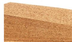
Pannello in sughero biondo densità 220 kg/m<sup>3</sup> | Conduttività termica dichiarata  $\lambda_p$ [W/(m\*k)] 0,052 | Calore specifico c 1.674 J/kg K
