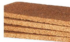
Pannello in sughero biondo densità 150÷160 kg/m<sup>3</sup> | Conduttività termica dichiarata  $\lambda_p$ [W/(m\*k)] 0,041 | Calore specifico c 1.674 J/kg K
