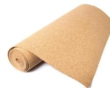
Rotolo in sughero biondo densità 150÷160 kg/m<sup>3</sup> | Conduttività termica dichiarata  $\lambda_p$ [W/(m\*k)] 0,041 | Calore specifico c 1.674 J/kg K
