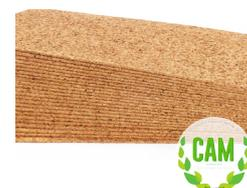
Pannello in sughero biondo densità 250÷300 kg/m<sup>3</sup> | Conduttività termica dichiarata  $\lambda_b$ [W/(m\*k)] 0,052 | Calore specifico c 1.900÷2100 J/kg K
