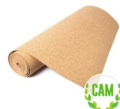
Rotolo in sughero biondo densità 180 kg/m<sup>3</sup> | Conduttività termica dichiarata  $\lambda_b$ [W/(m\*k)] 0,052 | Calore specifico c 1.900÷2100 J/kg K
